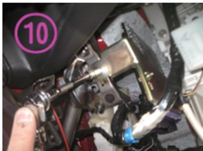
⑩ ECUの本体にも、固定の専用ブラケットが2個付いていますが、このブラケットが付いたまま、ECU本体を取り出します。落としたり、衝撃を加えないように慎重に取り扱ってください。
