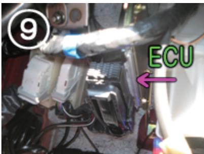
⑨ ロアカバーを外すと、色々な機構が見えます。画像⑨の写真が ECU の本体です。下部の黒いソケットカプラーが電源や各種の信号を送る、端子ソケットです。下側へ開くとソケットが外せます。
